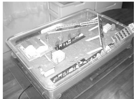
図-7 ジオラマを用いた実験装置で液状化現象を観察する。
